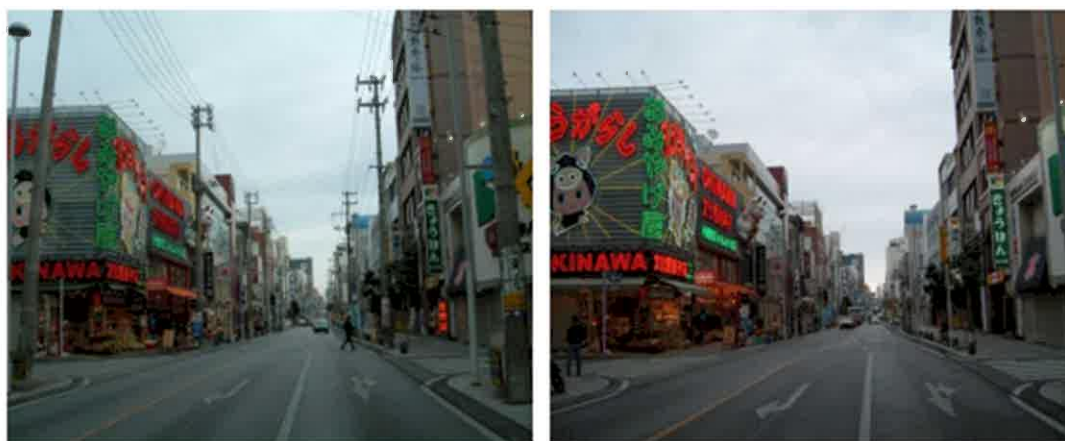
写真－２ 国際通り(那覇市)の整備前後の状況(左:整備前、右:整備後) [出典:沖縄県無電柱化推進計画(令和４年３月沖縄県土木建築部)]
